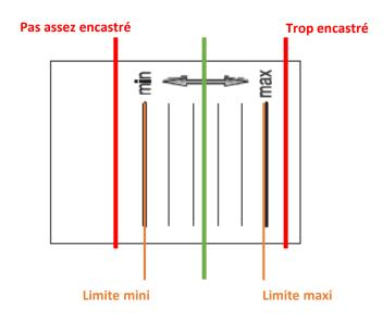
Retirer le capot et couper se qui dépasse du mur, en faisant attention à ne pas abimer le corps à l'intérieur (ne pas couper le corps).
